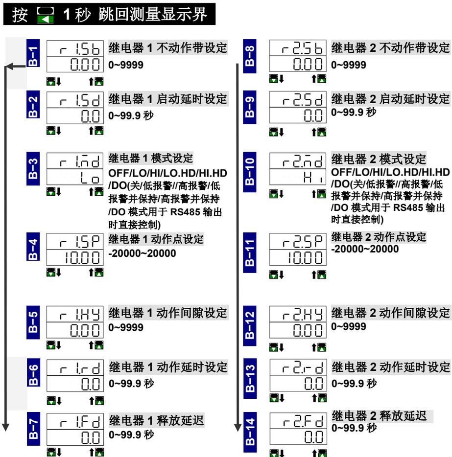
本系列仪表每一组继电器都有常开和常闭触点，可以通过连接继电器1和继电器2的不同触点加以继电器1和继电器2的报警设置能够组合成不同的继电器控制方式，具体需要根据控制方式咨询产品经销商
