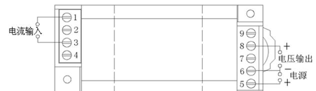
图 8、MCE-IJ03-\*\*\*MS1 电压输出接线参考
