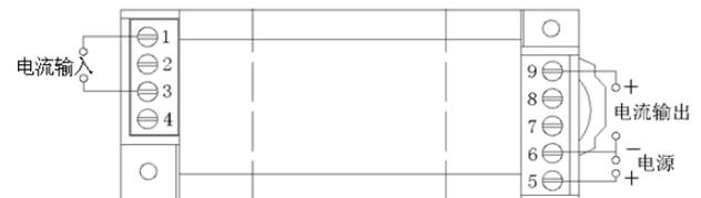
图 7、MCE-IJ03-\*\*\*MS1 电流输出接线参考
