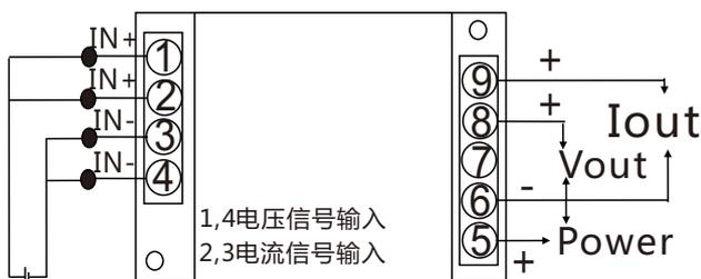
电流输入信号必须从电压输入信号的负极接入。其它未定义的引脚, 用户不能作为它用; 电流信号输出接9脚端子。
